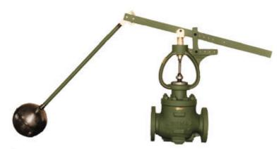
Válvula de control de nivel de líquidos actuada a flotante. Diseñada para mantener nivel modulando alrededor de una cota prefijada. Se basa en un sistema a flotante y brazo articulado, que acciona directamente al obturador de la válvula. Puede configurarse para abrir ó cerrar con aumento del nivel.
